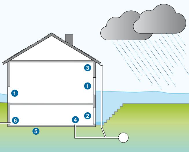
Starkregen und Hochwasser hinterlässt, wenn das Wasser in das Gebäude eindringt, zahlreiche Schäden. Neben der Beschädigung von Sachgegenständen leidet die Gebäudesubstanz durch Nässe, im Wasser enthaltene Verunreinigungen und Folgeschäden, insbesondere Schimmel. Optimal schützen Sie Ihr Haus mit einer Kombination aus verschiedenen baulichen Maßnahmen. Viele lassen sich beim Neubau und oftmals in Verbindung mit Umbau- oder Sanierungsmaßnahmen einfacher realisieren.
