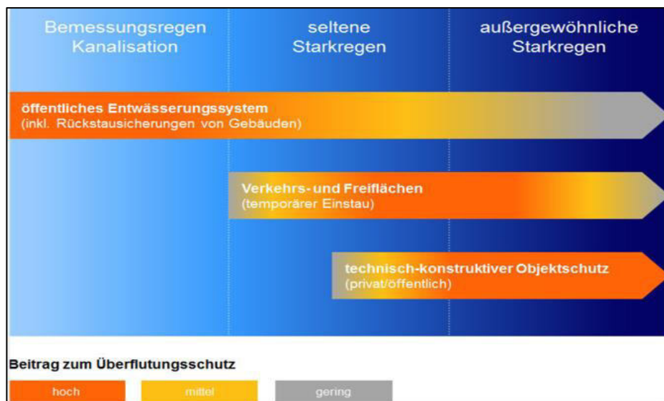
Abb.: Elemente des Überflutungsschutzes in unterschiedlichen Belastungsbereichen (Quelle: DWA)
