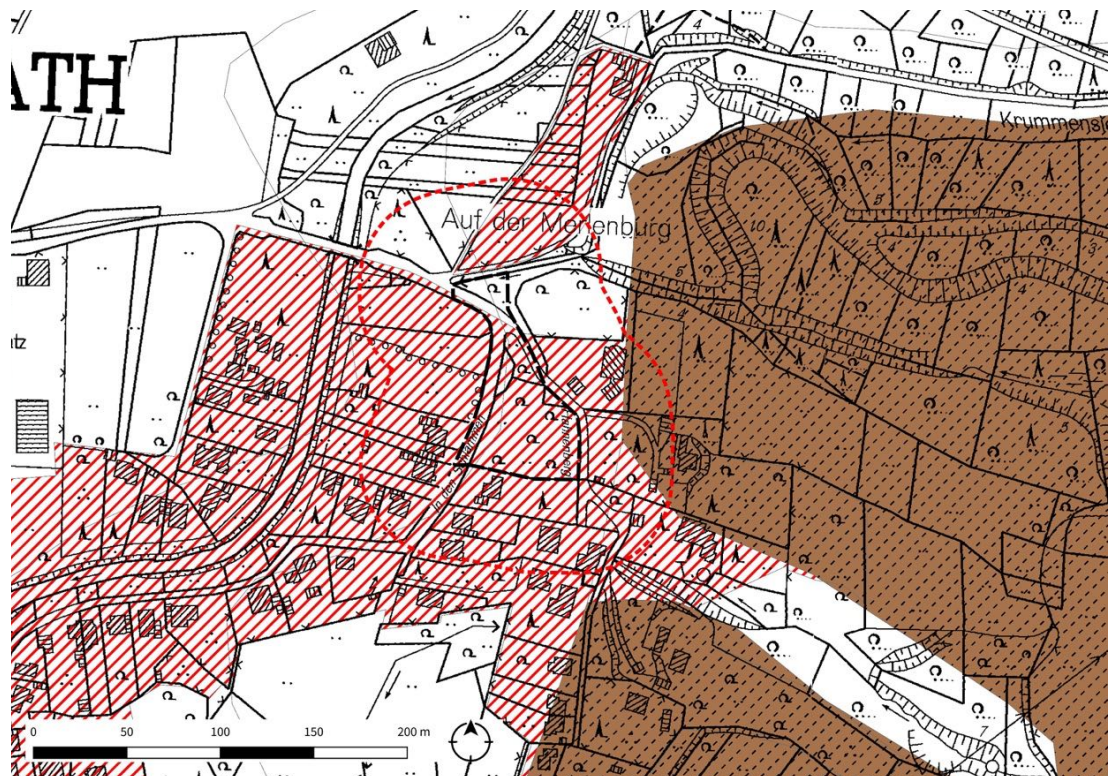
Abbildung 4 Bodenkarte des Untersuchungsgebietes (schwarze Umrandung), braun = Parabraunerde, rot schraffiert = Gley-Vega und Auengley
